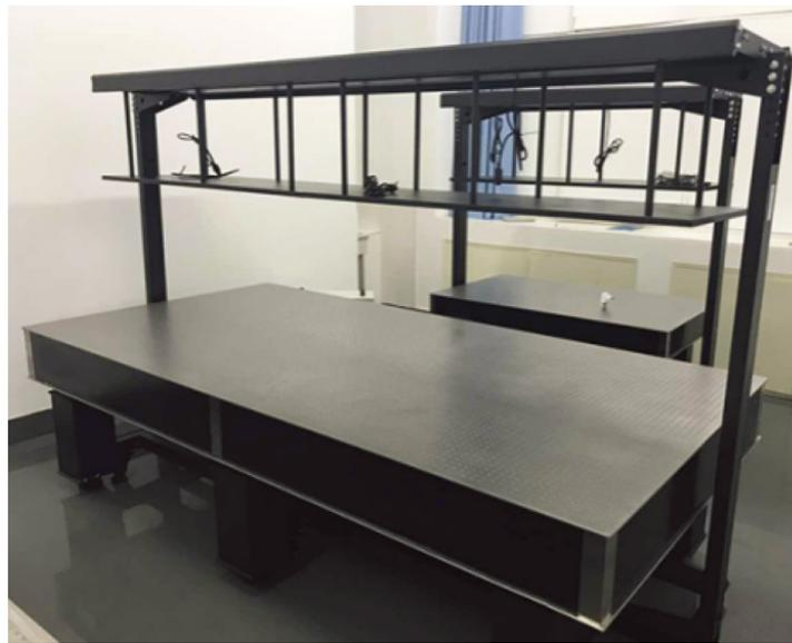
独立式落地仪器架充分合理的利用了平台上方立体空间，方便仪器摆放。整体采用龙骨结构，具有高强度的承载能力。所有仪器架安装插座，便于实验和操作，全系标配脚轮，仪器架配备遮光暗室安装孔，使用时可迅速支起安装。
