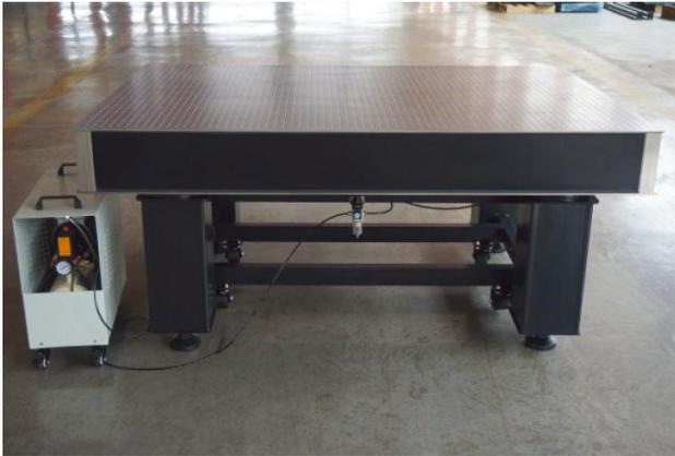
标准气浮隔振平台内部采用双腔气室结构，在降低固有频率的同时又加强了减振效果，搭配光学平台使用，全系配备脚轮，支架可定制无磁材质，（可选配膜片保护器）推荐对于振动要求较高的仪器使用。
