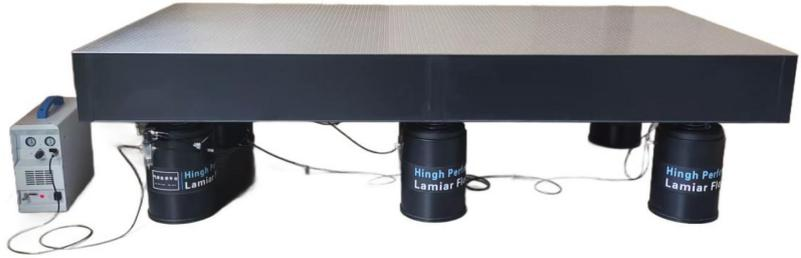
层流阻尼技术大大提高阻尼效率，混合腔设计极大增加给定的尺寸下的柔性体积，同时有效降低了固有频率（台面可选配 TMD 调谐质量阻尼器，详见右图）
